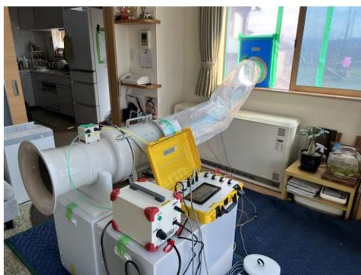
(導入した機器による機密性能測定)
